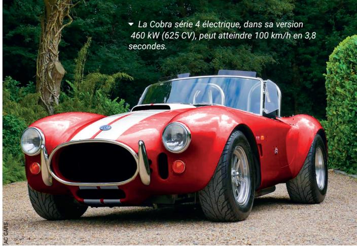
▼ La Cobra série 4 électrique, dans sa version 460 kW (625 CV), peut atteindre 100 km/h en 3,8 secondes.
